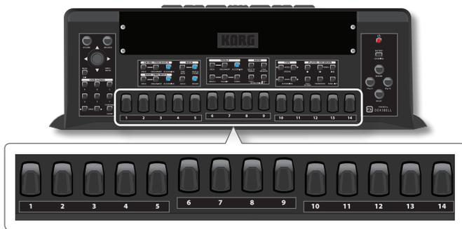
Um zum Beispiel die Bank „001“ aufzurufen, drücken Sie das Register „10“ (= 0), gefolgt von Register „1“. Um die Bank „056“ aufzurufen, drücken Sie das Register „5“, gefolgt von Register „6“. Um die Bank „100“ aufzurufen, drücken Sie zweimal das Register „10“.
