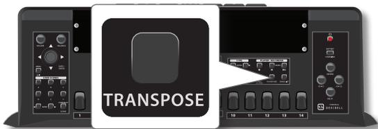
Die Taste leuchtet auf, um anzuzeigen, dass die Tastatur transponiert ist. Eine temporäre Seite zeigt den Transpositionswert an:
