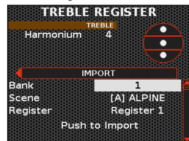
1. Wählen Sie mit dem [DATA/ENTER]-Regler die Scene (Bank und Scene) und das Register aus, aus dem kopiert werden soll.
