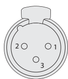
DMX-OUTPUT Connecteur XLR femelle 3 broches
