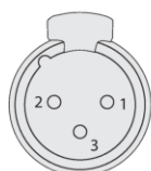
DMX-OUTPUT Connecteur XLR femelle 3 broches
