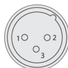
DMX-INPUT Connecteur XLR mâle 3 broches
