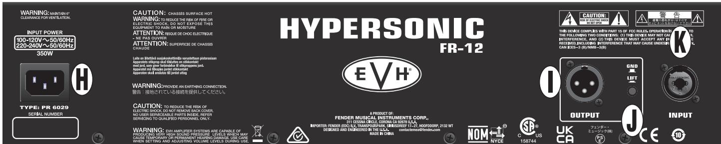
**H. IECインレット:**インレット横の入力電源の電圧と周波数に合わせて、接地されたコンセントに付属の電源コードを接続します。100V-240Vでのユニバーサル動作。
