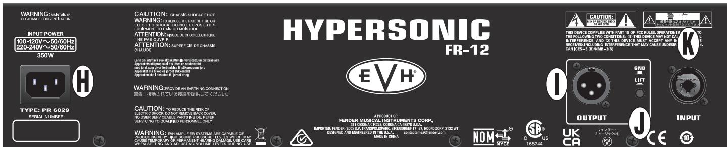
**H. IEC ANSCHLUSS:** Schließen Sie das mitgelieferte Netzkabel an eine geerdete Steckdose an, die der Eingangsspannung und -frequenz entspricht, die neben dem Netzanschluss angegeben ist. Geeignet für den Betrieb mit 100 V bis 240 V.
