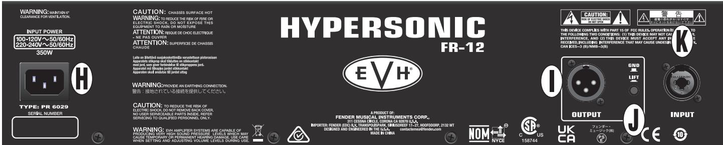
**H. CONECTOR IEC:** Conecte el cable de alimentación suministrado a un enchufe con toma de tierra y con una tensión y frecuencia acorde a los valores indicados sobre el conector. Alimentación universal de 100 a 240 V.
