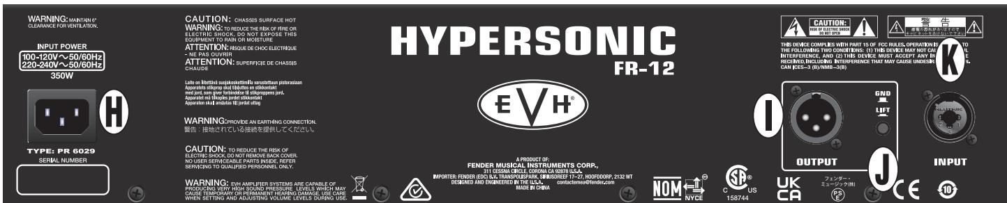
**H. CONNETTORE IEC:** Collegare il cavo di alimentazione in dotazione a una presa dotata di messa a terra con la tensione e la frequenza indicate sopra il connettore. Alimentazione universale nell'intervallo 100-240 V.
