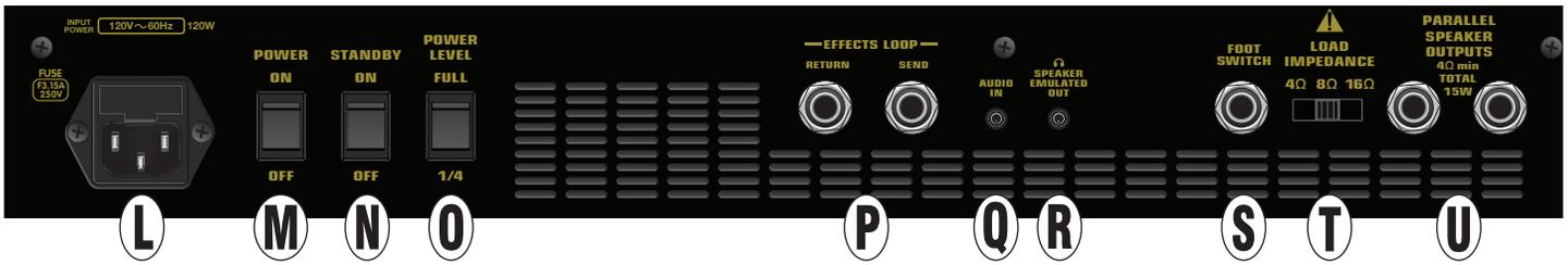
**L. 电源输入接口 (POWER INPUT):** 根据放大器后面板上列出的额定电压和频率, 将随附的电源线插入到此接口。电源输入接口的一体式保险丝架上有一个备用保险丝。如烧断了保险丝, 请仅用具有与印在放大器背面的电流和电压额定值相同规格的保险丝来替换。
