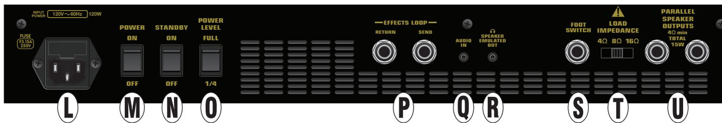
**L. ALIMENTAÇÃO:** Conecte o cabo de alimentação fornecido nesta entrada observando os valores de tensão e frequência no painel traseiro do amplificador. O porta-fusível integral da entrada de alimentação contém um fusível de substituição. Use somente fusíveis com a mesma corrente e voltagem referidas na parte traseira do amplificador.
