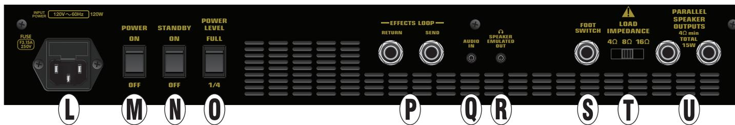
**L. POWER INPUT (電源輸入):** 根據放大器後面板上列出的電壓和頻率額定值, 在此處將隨附的電源線連接到放大器。電源輸入的一體式保險絲座裝有備用保險絲。只能使用與放大器背面印製的電流和電壓額定值相同的保險絲進行更換。
