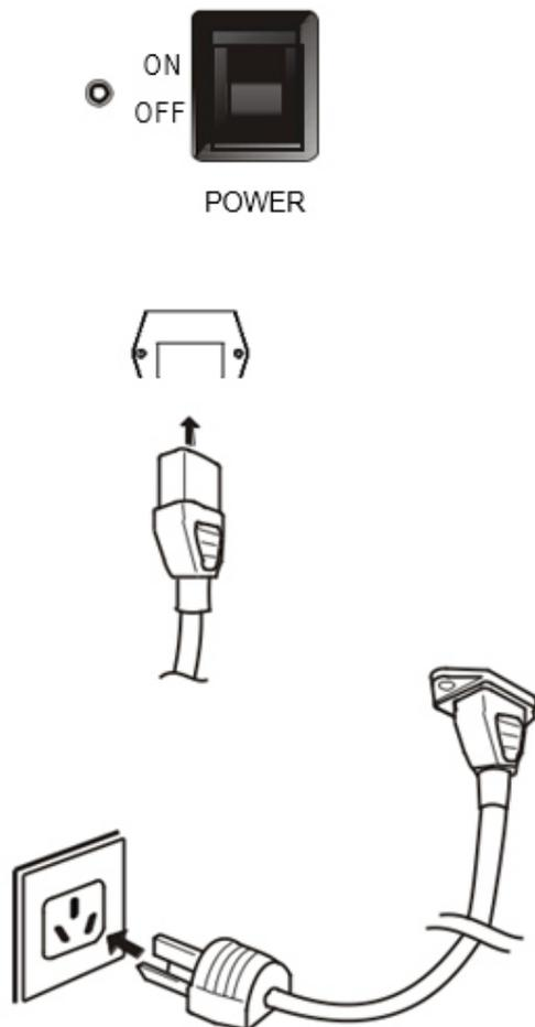
1. Stellen Sie sicher, dass der Verstärker ausgeschaltet ist, während Sie das Gerät an den Strom anschließen oder von der Stromquelle entfernen.
