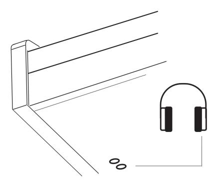
Die beiden 6,3mm Kopfhöreranschlüsse an der Unterseite des Spieltischs können gleichzeitig genutzt werden. Beim Anschluss eines Kopfhörers werden die Lautsprecher des Instruments deaktiviert.
