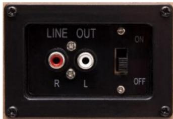
Wenn Sie die Jukebox mit den integrierten Lautsprechern betreiben möchten, so schalten Sie den Schalter am schwarzen LINE OUT-Display auf der Rückseite der Box auf **OFF**. Möchten Sie externe Lautsprecher anschließen (LINE OUT) dann schieben Sie den Schalter auf ON und benutzen bitte die Cinch-Ausgänge wie links zu sehen.
