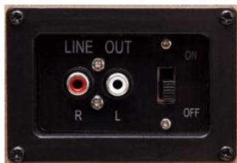
Si vous voulez utiliser le juke-box avec les haut-parleurs intégrés, mettez l'interrupteur sur l'écran noir LINE OUT à l'arrière du boîtier sur **OFF**. Si vous souhaitez connecter des haut-parleurs externes (LINE OUT), mettez l'interrupteur sur ON et utilisez les sorties RCA comme indiqué à gauche.
