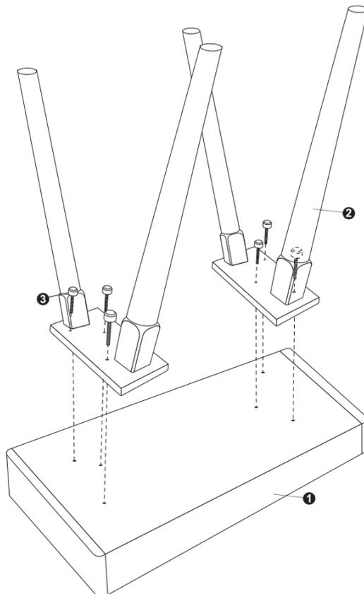
Befestigen Sie die Aufnahmeplatten mit den montierten Standbeinen (2) mit Hilfe der sechs Kunststoffkopfschrauben (3) sicher am Spieltisch.
