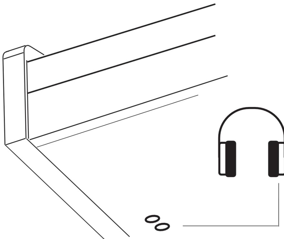
Die beiden 6,3mm Kopfhöreranschlüsse an der linken hinteren Unterseite des Spieltisches können gleichzeitig genutzt werden. Beim Anschluss eines Kopfhörers werden die Lautsprecher des Instruments deaktiviert.
