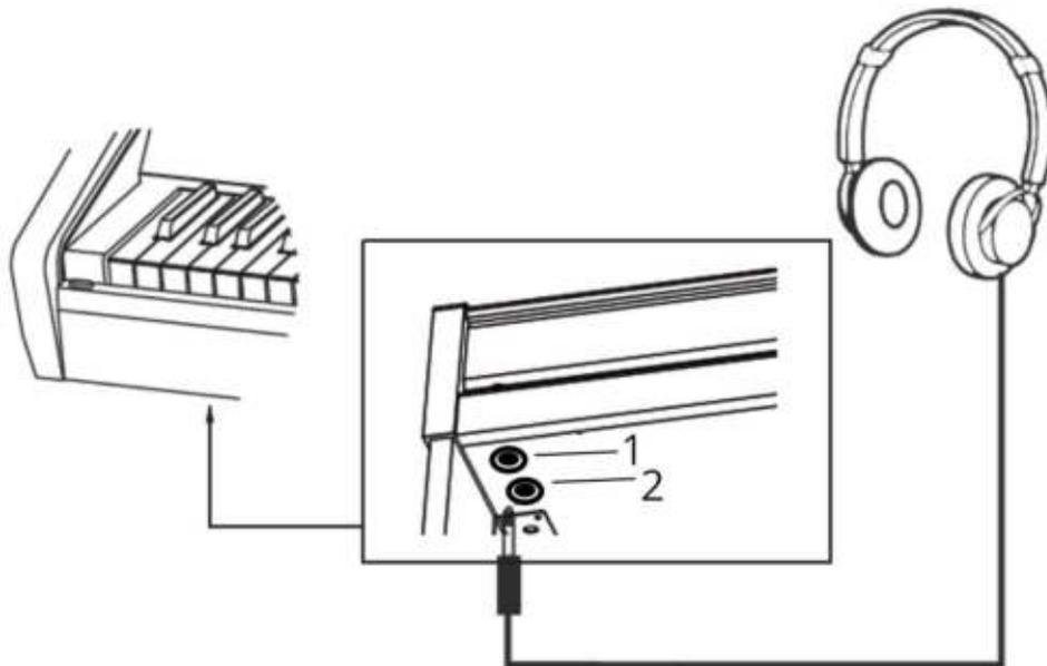
Die beiden Kopfhöreranschlüsse an der linken Unterseite des Spieltisches können gleichzeitig genutzt werden. Beim Anschluss eines Kopfhörers an die Kopfhörerbuchse 1 wird der Klang des Instruments über die Kopfhörer und zusätzlich weiterhin über die Lautsprecher wiedergegeben. Beim Anschluss an die Kopfhörerbuchse 2 werden die Lautsprecher des Instruments deaktiviert.
