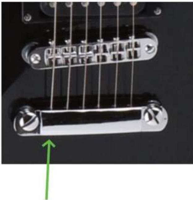
Sollte Dein Saitenhalter so aussehen, führst Du das spitze Ende der neuen Saite von der Rückseite Deiner Gitarre durch den Saitenhalter. Das Ball-Ende Deiner Saite verschwindet durch das Loch in der Rückseite der Gitarre und hält somit die Saite.
