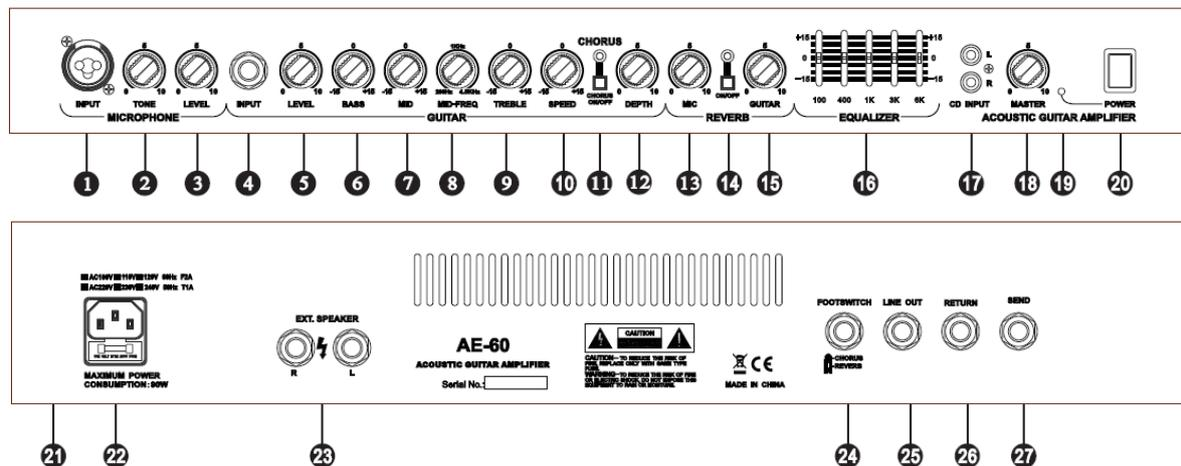
1. **Mikrofon Eingang (Kombibuchse):** Schließen Sie an dieser Buchse ein dynamisches Mikrofon per XLR- oder 6,3mm Klinkenkabel an.
