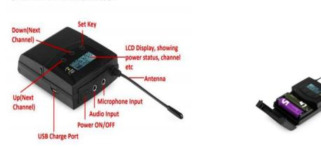
**Batterien:** Bitte verwenden Sie 2 hochwertige 1,5 V AA-Batterien Alternativ können Akkus vom Typ 1,2V 800 mAh verwendet und direkt mit SDT BP-30 geladen werden.
