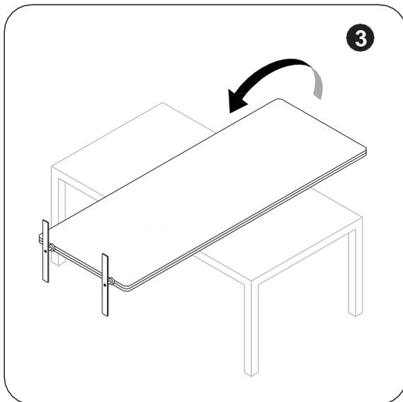
Nehmen Sie das Trennpanel vorsichtig von der flachen Oberfläche herunter und bringen Sie es in eine sichere Standposition. Die besten Ergebnisse erhalten Sie, wenn die Standbeine auf einem flachen, ebenen Untergrund stehen. Vergewissern Sie sich vor der Nutzung dass die FüÙe gut und sicher mit der Platte verbunden sind.
