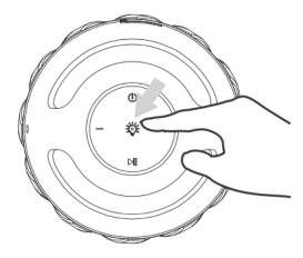
Flammenlampe EIN/AUS Taste auf der Geräte-Oberseite (mittig) **kurz** Drücken, um die Lampe aus oder an zu schalten.
