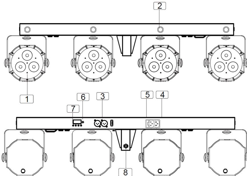
Die Komplettlichtanlage verfügt über vier LED RGB PAR Spots (1) und vier LED W Strobe Spots (2).
