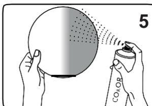
Der Lautsprechergrill kann auch bei Bedarf farblich an die Einbaufäche angepasst werden. Schleifen Sie dazu den Grill mit einem sehr feinen Sandpapier leicht an und benutzen Sie einen handelsüblichen Lack (z.B. Acryl- oder Autolack) zum Überlackieren.
