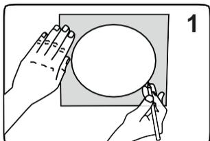
Benutzen Sie die im Lieferumfang enthaltene Einbauschablone. Übertragen Sie den Einbauausschnitt auf die Montagefläche. Schneiden Sie mit einer Stich- oder Handsäge das Montage Loch aus.
