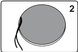
Verlegen Sie die Lautsprecherkabel vom Verstärker zu den Lautsprechern. Verwenden Sie nur hochwertige Kabel mit ausreichendem Querschnitt. Das Ende der Leitung sollte ca. 30cm aus dem Ausschnitt herausragen.
