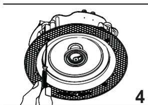
Setzen Sie den Lautsprecher ein und ziehen Sie mit einem Schraubenzieher die Befestigungsschrauben an. Drücken Sie hierzu den Lautsprecher gegen die Einbaufäche um einen guten Sitz zu gewährleisten.
