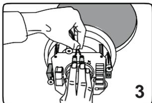
Schließen Sie die Kabel an den dafür vorgesehenen Klemmen an. Beachten Sie dabei die Ausgangsimpedanz des Verstärkers und der Lautsprecher. Die Impedanzen müssen übereinstimmen. Durch Parallel- oder Reihenschaltung können Sie unterschiedliche Impedanzen erzielen. Siehe Abbildung rechts. Achten Sie auf richtige Polung der Lautsprecher.
