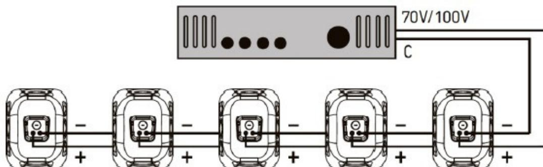
**HINWEIS:** Die Wattleistung eines einzelnen Lautsprechers, multipliziert mit der Anzahl der genutzten Lautsprecher darf die Ausgangsleistung (in Watt) des genutzten Verstärkers (70V / 100V) nicht überschreiten.
