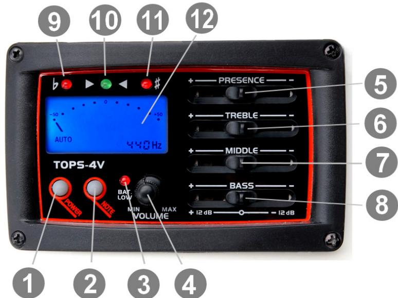
1. Stellen Sie sicher dass sich im Batteriefach (15) eine 9V Blockbatterie mit gutem Ladezustand befindet. Niedriger Batteriestand wird Ihnen mit der LED (3) angezeigt
