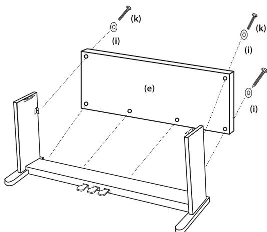
Befestigen Sie nun die Rückwand (e) an Seitenteilen und Pedalkasten mit 2 Bolzen (k), 4 Schrauben (j) und 6 Beilagscheiben (i).
