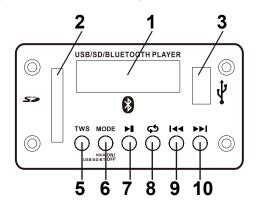
Der Player spielt Audiofiles der folgenden Formate: MP3 und WAV Stecken Sie eine SD-Card oder einen USB-Stick in einen der Slots/Ports (2)oder (3). Mit der Taste MODEschalten Sie den Player An/Aus. Mit der Taste PLAY/PAUSE starten bzw. unterbrechen sie den Song/Track an der aktuellen Position. Die Taste STOP hält die Wiedergabe an. Track 1 wird ausgewählt.
