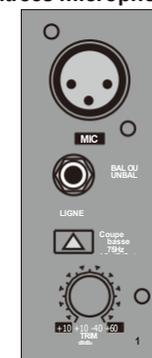
Fig. 2.1 : Connecteurs et commandes des entrées micro/ligne
