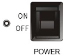
1. Stellen Sie sicher, dass der Verstärker ausgeschaltet ist, während Sie das Gerät an den Strom anschließen oder von der Stromquelle entfernen.
