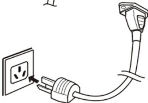
3. Stecken Sie das Stromkabel in die Steckdose.
